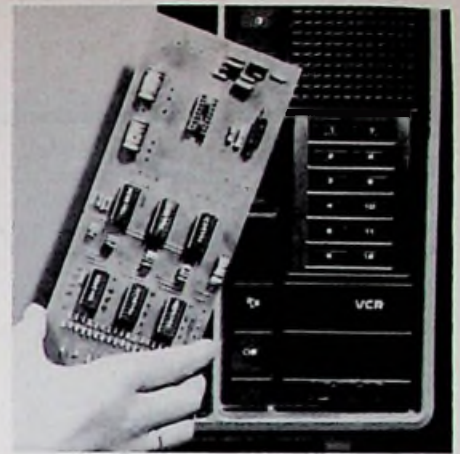
Afb. 17. Proefschakeling voor 12 programma's. In de lege IC-voet behoort een TDA2610.
